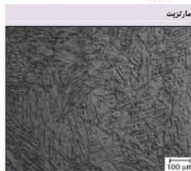
شکل ۳) پوسته پمپ طبقاتی از جنس فولاد زنگ زن مارتنزیتی
