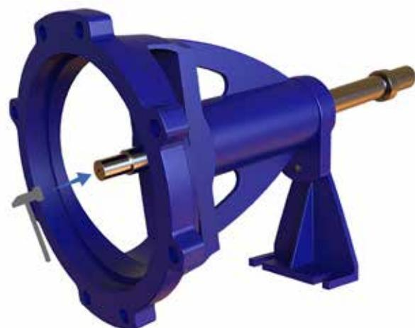
شکل ۲۵- خارج نمودن محور از روی پایه یاتاقان
