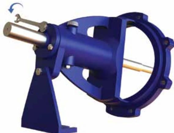
شکل ۲۴- باز کردن دریوش بلبرینگ
