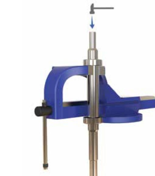
شکل ۲۶- خارج نمودن بلبرینگ از محور
