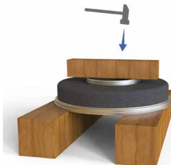
شکل ۲۷- سوار کردن رینگ سایشی
